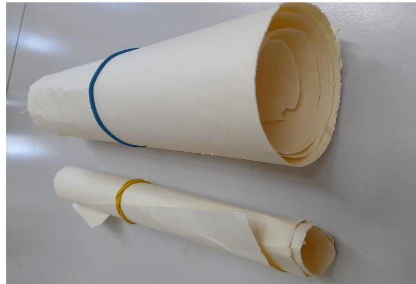
Лабораторные образцы бумаги, изготовленные двумя различными способами: на листоотливном аппарате системы «Rapid-Köthen» (слева), на динамическом листоотливном аппарате (справа).
